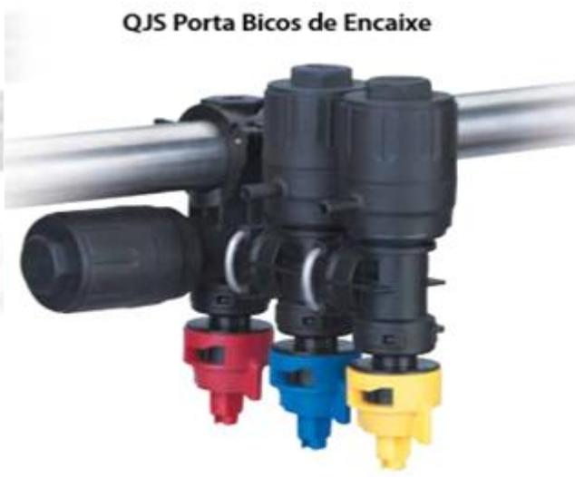
**Fig. 3** - Os porta bicos permitem a alteração da vazão e tamanho de gotas de forma prática e segura pelo responsável pela aplicação de agrotóxicos (Fonte: TEEJET)
