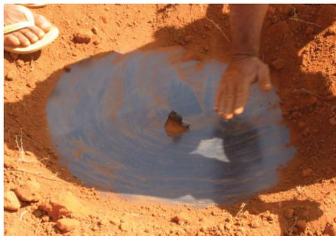
**Figura 30. Furo na lona causado pela movimentação da enxada.**
