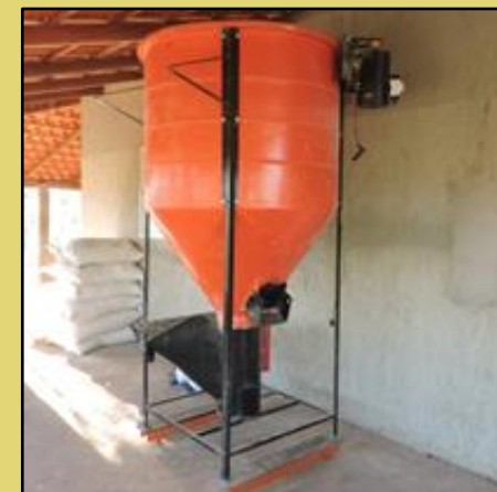
Figura 2. Misturador de ração.
