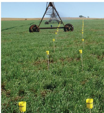
**Figura 38. Coletores para avaliação da uniformidade em um sistema pivô central.**
