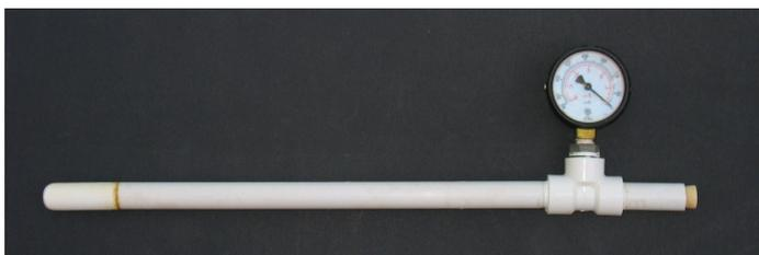
**Figura 50. Modelo de tensiômetro.**
