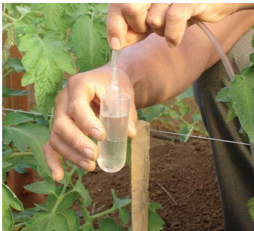
**Figura 53. Avaliação da umidade do solo com o Irrigas.**
