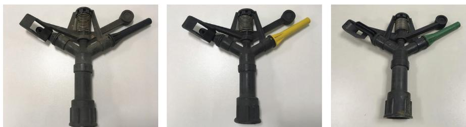
**Figura 54. Troca do bico longo verde (diâmetro 5 mm) por bicos longo preto (diâmetro 3 mm) ou longo amarelo (diâmetro 4 mm) no mesmo aspersor para diminuir a vazão.**
