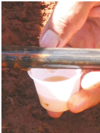
**Figura 39. Coleta de água para avaliação da uniformidade em sistema de gotejamento.**
