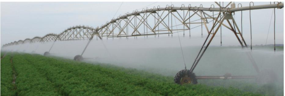
**Figura 31.** Pivô central com emissores mais próximos ao solo.
