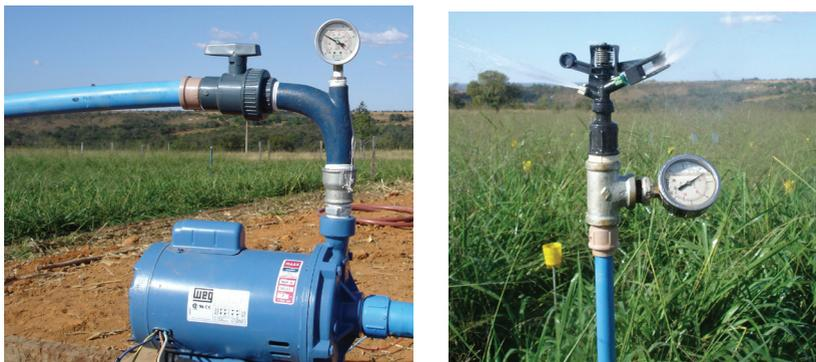
**Figura 37. Medição da pressão na saída da bomba e no emissor.**
